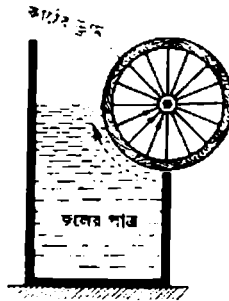
চিত্র ৫৩ : ‘জল-চালিত “নিরবচ্ছিন্ন গতি” সম্পন্ন যন্ত্রের আর একটি প্রকল্প।
